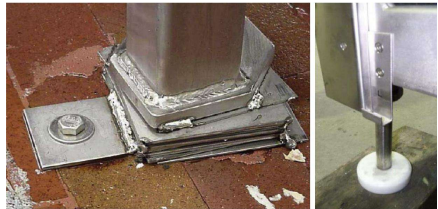
A). Một số tấm kim loại dùng để cân bằng thiết bị có thể tích tụ bụi bẩn và chất lỏng. (B). Tấm gỗ dùng để cân bằng thiết bị có thể hút ẩm và bám bụi thực phẩm.
