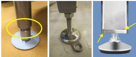
Chân để điều chỉnh với trục ren lộ để bị bám bẩn và khó làm sạch
